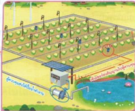
เซ็นเซอร์ตรวจวัดความชื้นในดิน ส่งสัญญาณให้ปั๊มน้ำทำงาน
